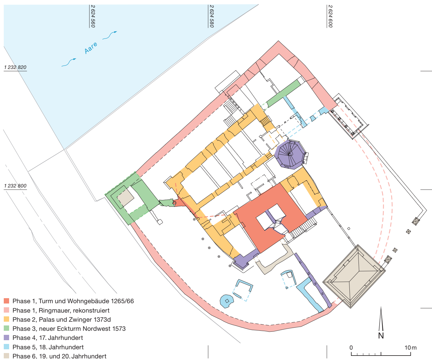
3 Aarwangen, Schloss. Grundriss auf dem Erdgeschossniveau mit den verschiedenen Bauphasen. M. 1:400.
